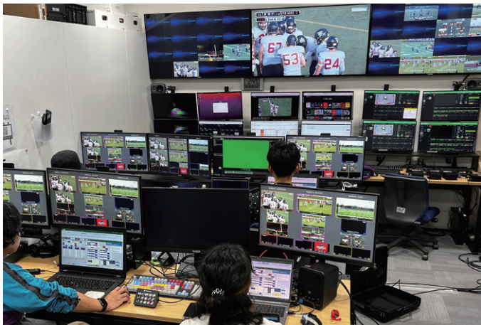
▲ライブ配信のリモートサブの様子。この日は複数の競技場からの映像にテロップ・CM挿入等を行う番組制作が行われた
